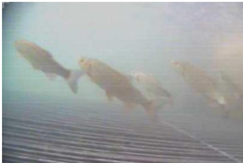
**Abbildung 4: Unterwasserfoto vom Fischverhalten über dem Horizontalrechen (Versuchsanstalt Obernach)**
